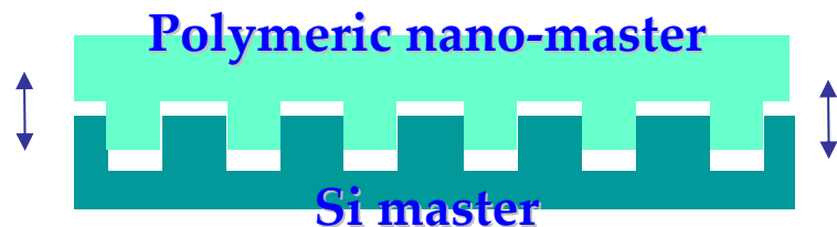
(d) Fabrication of polymeric nano-master by UV molding
